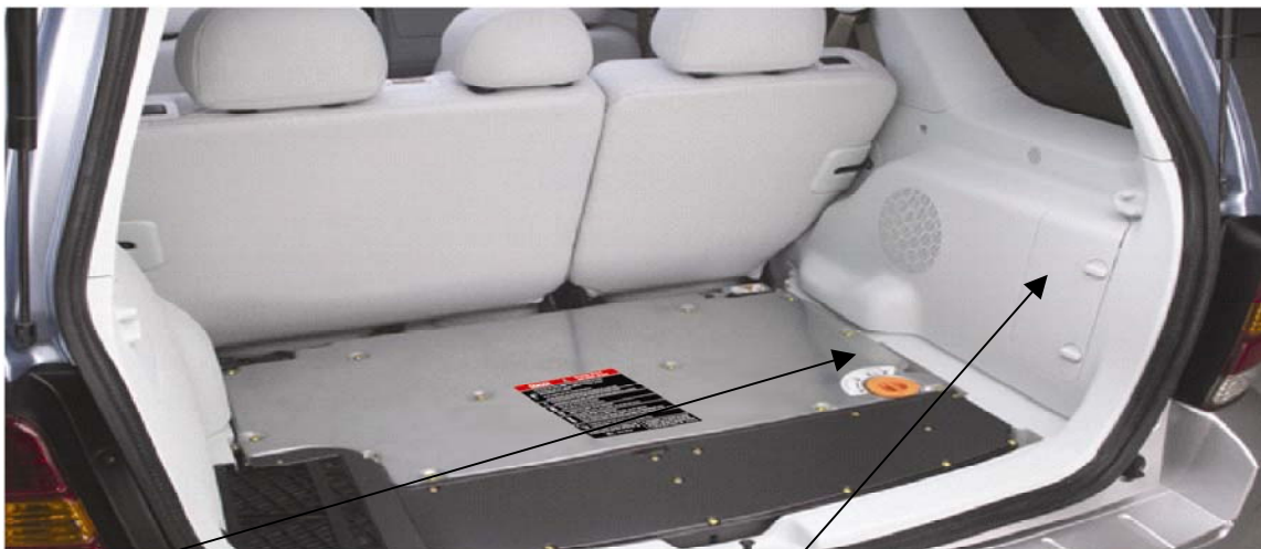
Interrupteur de coupure haute tension pour intervention Interrupteur à inertie situé derrière ce panneau
