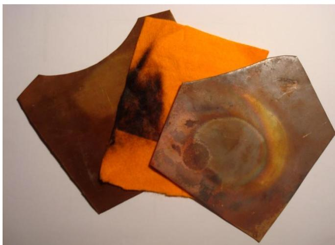
Figure 11 - Feutre comme isolant. Ici le feutre orange entre 2 plaques de cuivre. Document personnel
